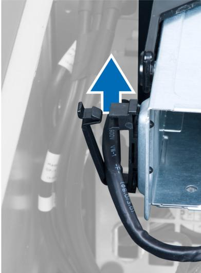
7. Heben Sie den Entriegelungsriegel oben auf dem Träger des optischen Laufwerks an.
