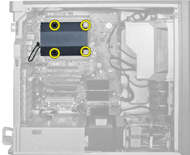
5. Heben Sie den Kühlkörper an und entfernen Sie ihn aus dem Computer.
