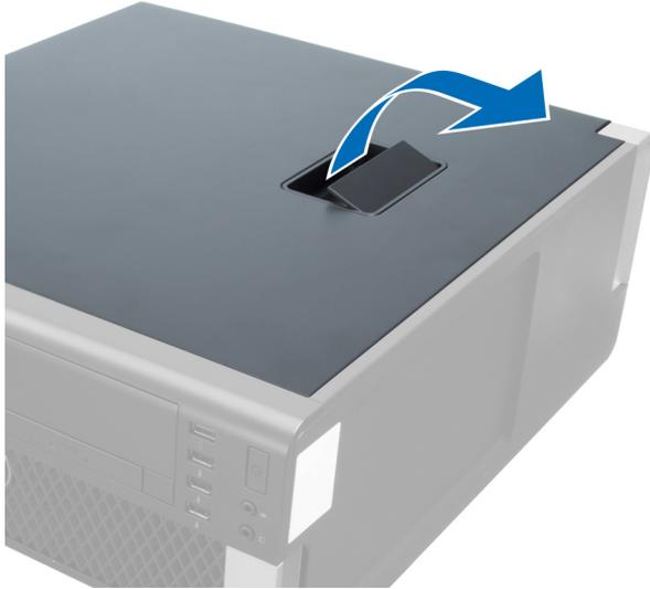
4. Heben Sie die Abdeckung in einem Winkel von 45 Grad an und entfernen Sie sie vom Computer.
