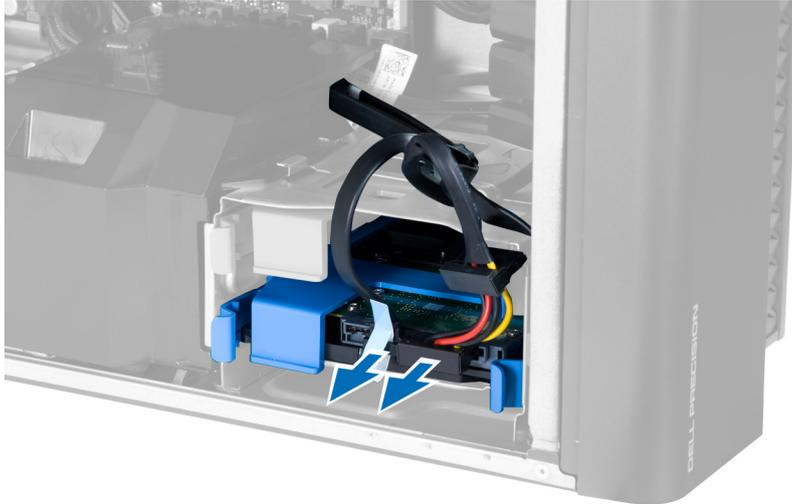
4. Drücken Sie auf die Riegel auf jeder Seite der Festplattenlaufwerkhalterung.
