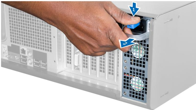
4. Erfassen Sie den Griffbügel, um das Netzteil aus dem Computer zu schieben.
