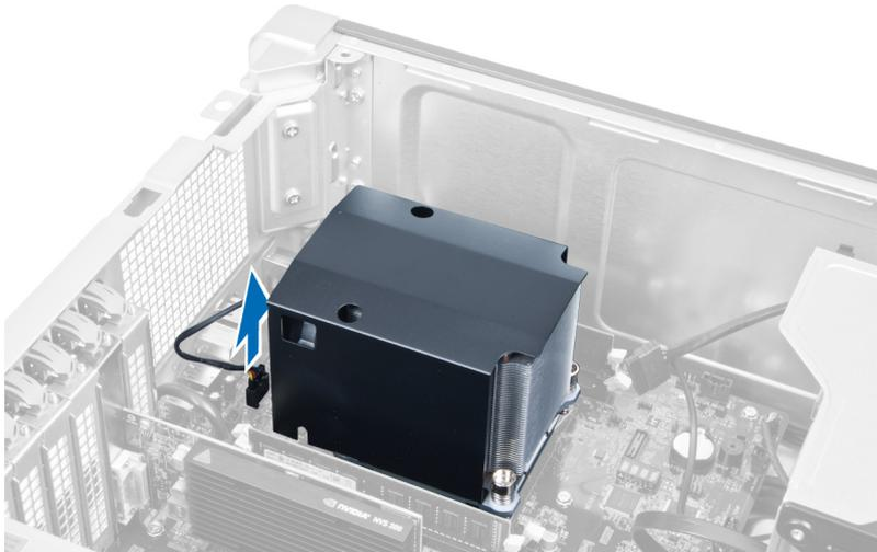
4. Lösen Sie die Schrauben, mit denen der Kühlkörper befestigt ist.
