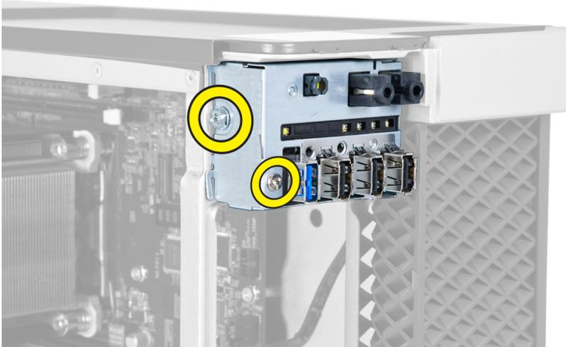
4. Entfernen Sie das USB 3.0-Modul vom Gehäuse.
