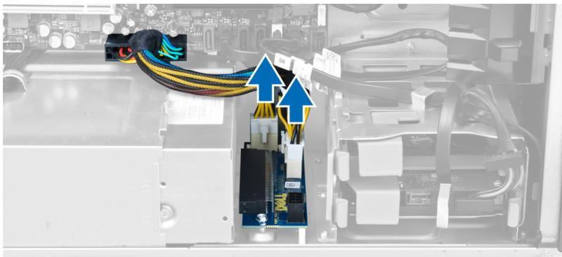
6. Entfernen Sie die Schrauben, mit denen die Netzteilkarte am Steckplatz befestigt ist.
